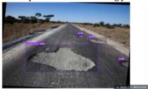
Gambar 11. Hasil Deteksi Jalan Berlubang Menggunakan Webcam Real-time
